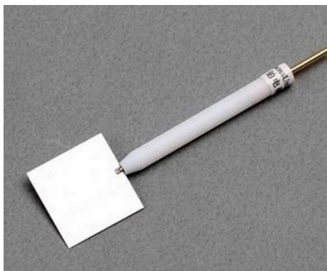
Slika 14. Platinska pločica kao elektroda [35]
