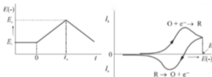
Slika 24- Signal pobude i signal odziva za cikličku voltometriju
