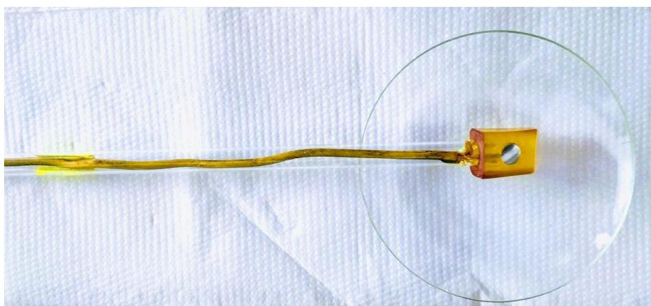
**Slika 13.** Radna Sn elektroda.
