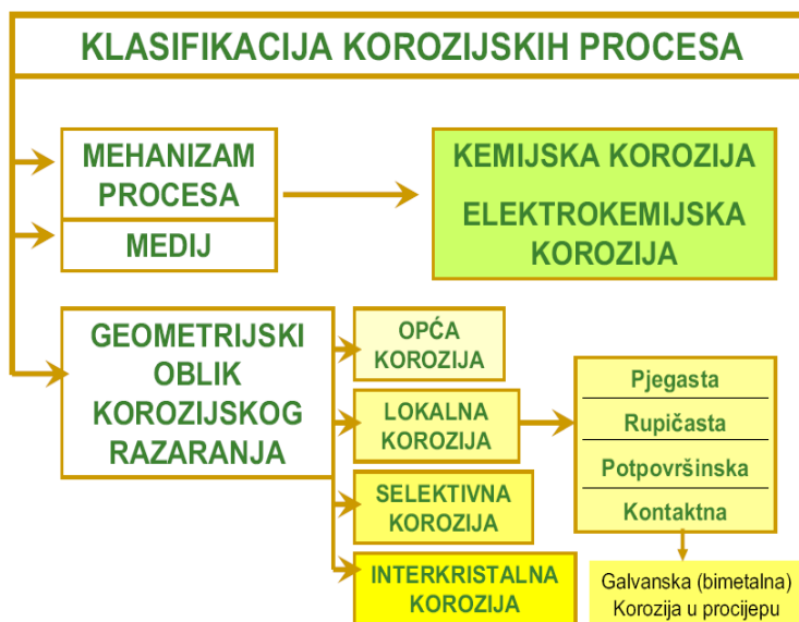
Slika 13. Klasifikacija korozijskih procesa
