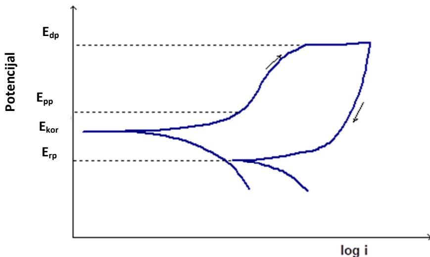
Slika 1.10. Ciklička polarizacijska krivulja s pozitivnom petljom
