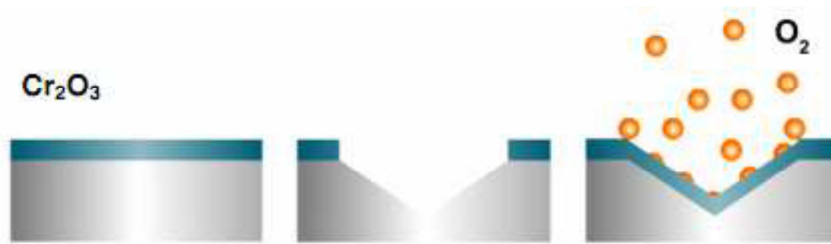
Slika 1.5. Prikaz mehanizma samoobnavljanja pasivnog filma kromovih oksida na površini
