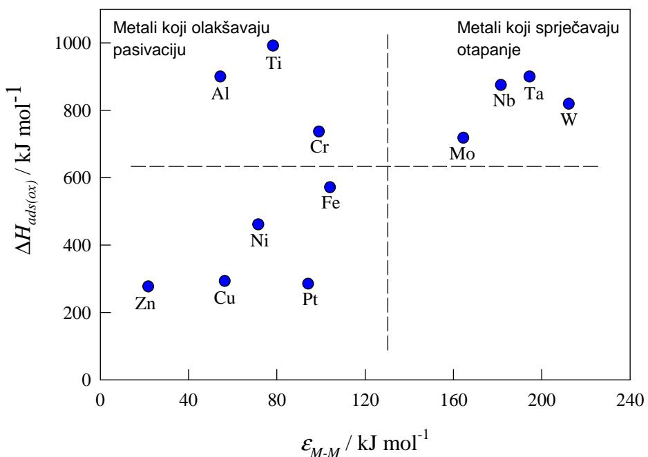
**Slika 4.5.** Legirajući elementi koji olakšavaju pasivaciju te elementi koji priječe otapanje metala na osnovu ovisnosti  $\Delta H_{ads(ox)}$  o  $\varepsilon_{M-M}$ <sup>24</sup>
