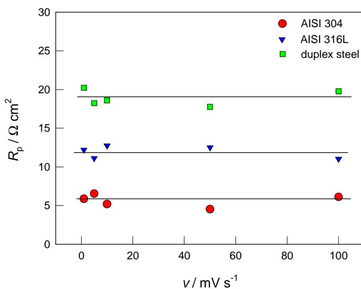
**Slika 4.4.** Ovisnost polarizacijskog otpora ispitivanih uzoraka nehrđajućeg čelika o brzini promjene potencijala u  $0.5 \text{ mol dm}^{-3}$  NaCl otopini
