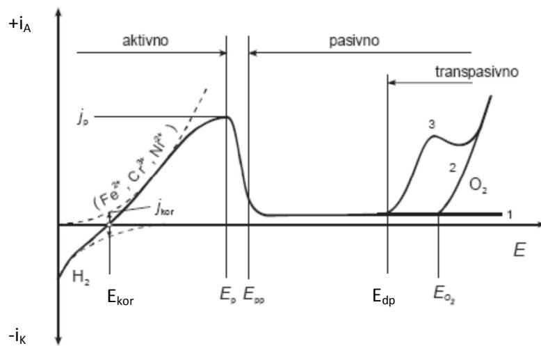
**Slika 1.8.** Shematski i-E prikaz pasivacijskog procesa za metale Fe, Ni, Cr<sup>17</sup>
