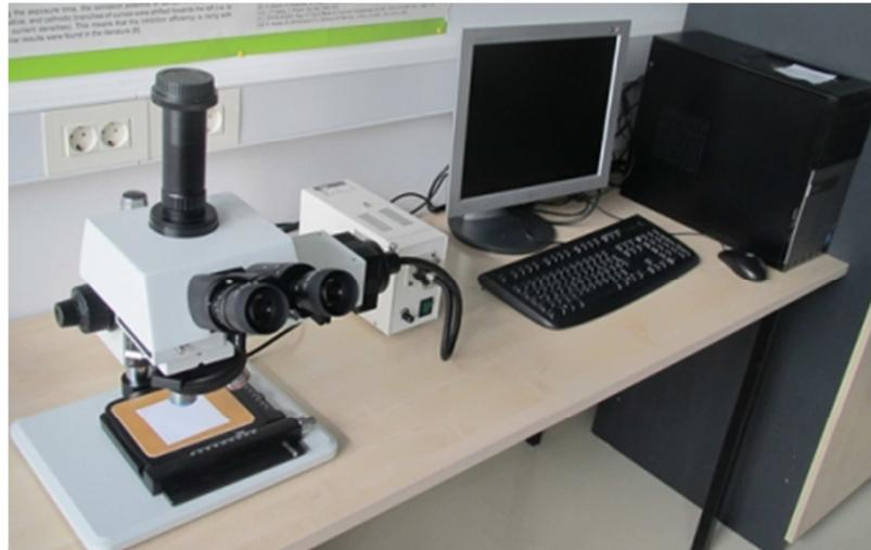
**Slika 2.3.** Optički mikroskop MXFMS-BD, Ningbo Sunny Instruments co.
