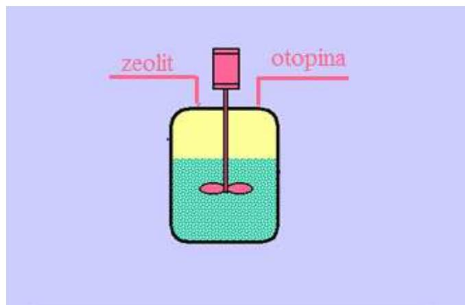
Slika 1.12. Prikaz izvedbe šaržnog postupka
