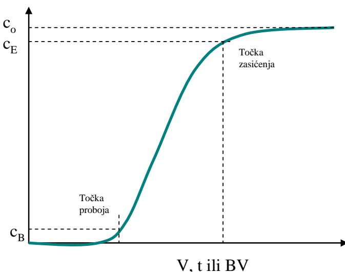
Slika 1.15. Shematski prikaz napredovanja postupka u koloni – krivulja probaja<sup>21</sup>
