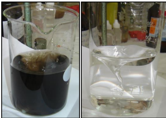
Slika 2.6. Prijelaz boje pri titraciji kod određivanja BPK 45 .
