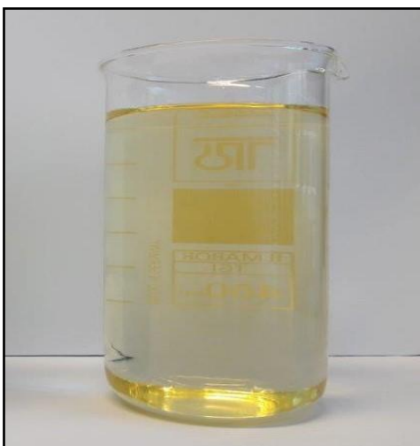
Slika 2.8. Uzorak nakon dodatka vapna uz namještanje pH i aeraciju.
