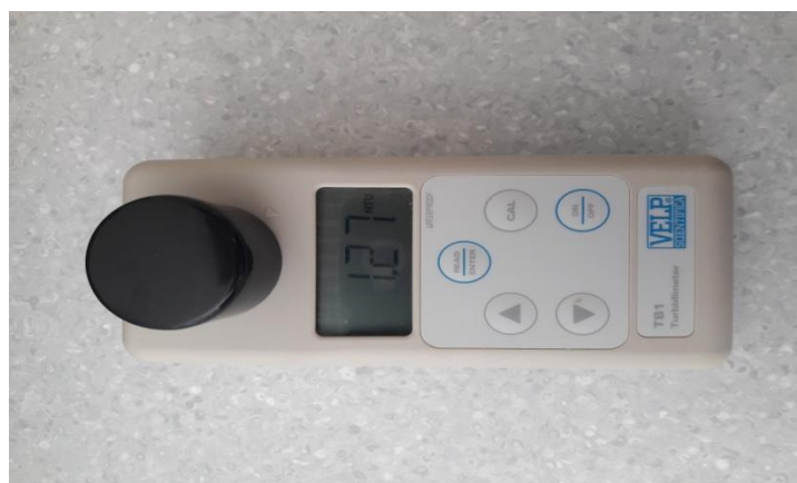
Slika 2.5. Turbidimetar korišten u eksperimentu
