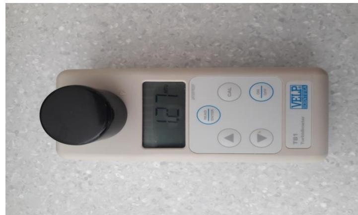
Slika 2.5. Turbidimetar korišten u eksperimentu
