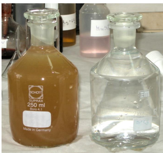
Slika 2.6. Izgled uzorka prije i nakon dodatka 2mL koncentrirane sulfatne kiseline
