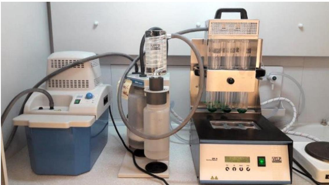
Slika 2.7. Aparatura za određivanje dušika po Kjeldahlu
