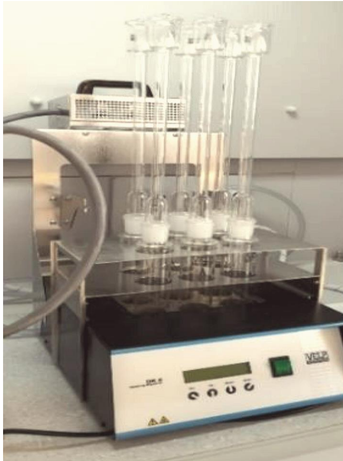
Slika 2.5. Aparatura za određivanje KPK
