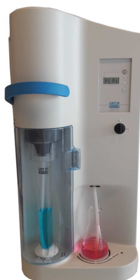
Slika 2.9. Uređaj za destilaciju uzorka.
