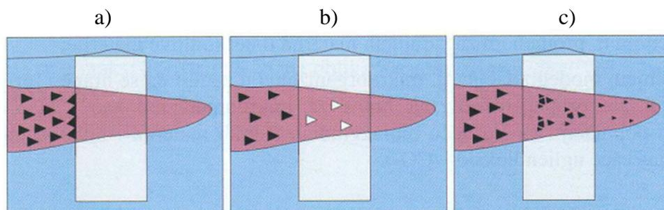
Slika 1.4. Shematski prikaz sorpcije, taloženja i razgradnje u propusnoj reaktivnoj barijeri.<sup>20</sup>
