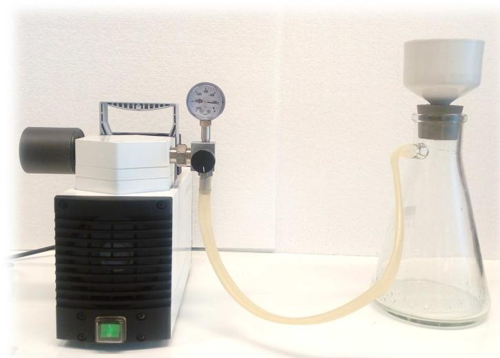
Slika 2.3. Sustav za vakuum filtraciju.
