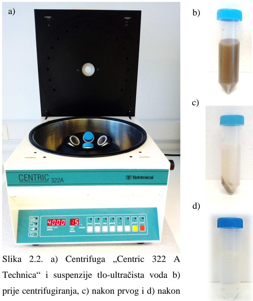
Slika 2.2. a) Centrifuga „Centric 322 A Technica“ i suspenzije tlo-ultračista voda b) prije centrifugiranja, c) nakon prvog i d) nakon drugog centrifugiranja.
