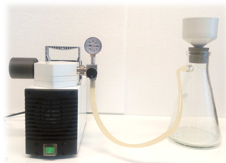
Slika 2.3. Sustav za vakuum filtraciju.
