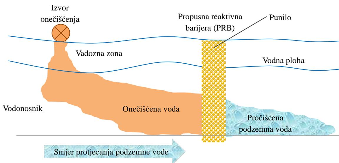
Slika 1.3. Shematski prikaz propusne reaktivne barijere.<sup>21</sup>
