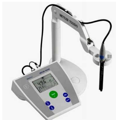
Slika 2.4. Uređaj za mjerenje pH vrijednosti Mettler Toledo
