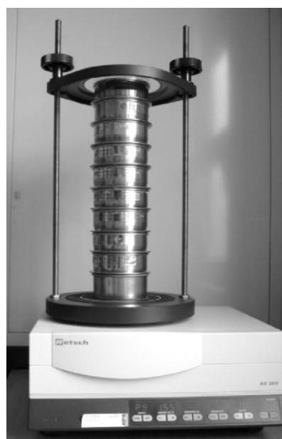
**Slika 10.** Aparatura za provedbu granulometrijske analize prosijavanjem.
