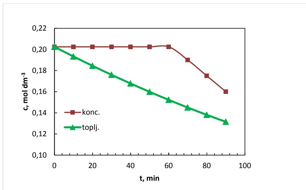
**Slika 14.** Promjena koncentracije i topljivosti boraksa u matičnoj otopini zasićenoj pri  $30\text{ }^{\circ}\text{C}$  i hlađenoj brzinom od  $6\text{ }^{\circ}\text{C h}^{-1}$ .
