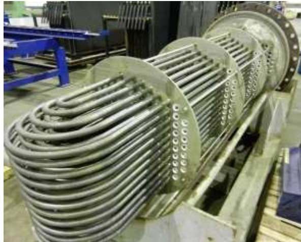
Slika 5. Izmjenjivač topline sa cijevnim snopom 10
