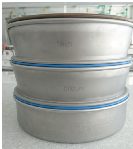
Slika 11. Sita veličina očica: 1 mm i 500 µm
