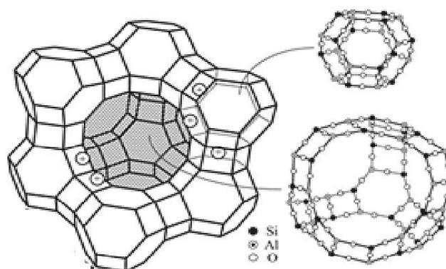
Slika 1.1. Prikaz strukture zeolita.<sup>(11)</sup>
