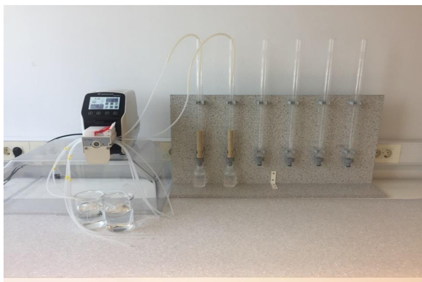
Slika 2.2. Laboratorijska kolona u kojoj je proveden eksperiment.
