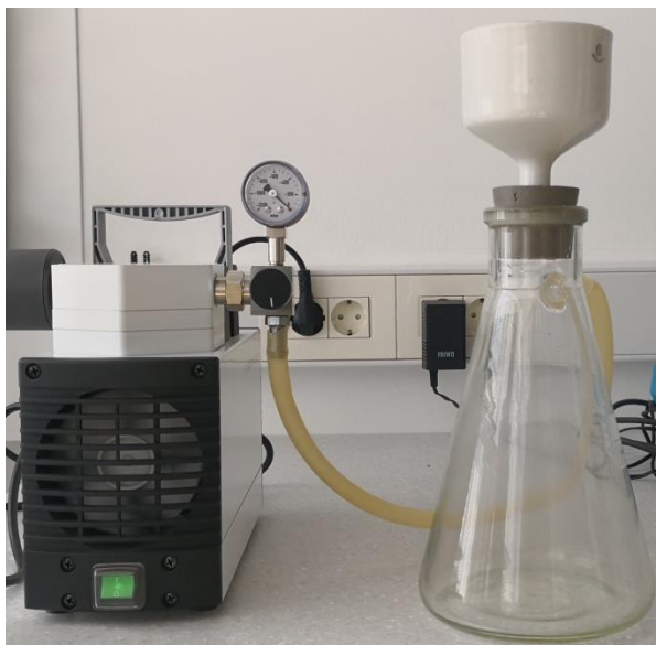
Slika 2.1 Aparatura za vakuum filtraciju.
