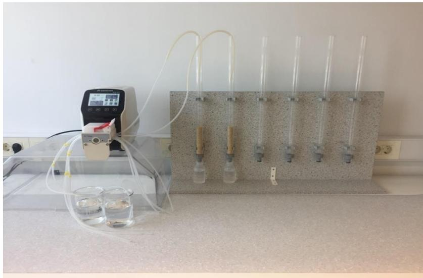
Slika 2.2. Laboratorijska kolona u kojoj je proveden eksperiment.
