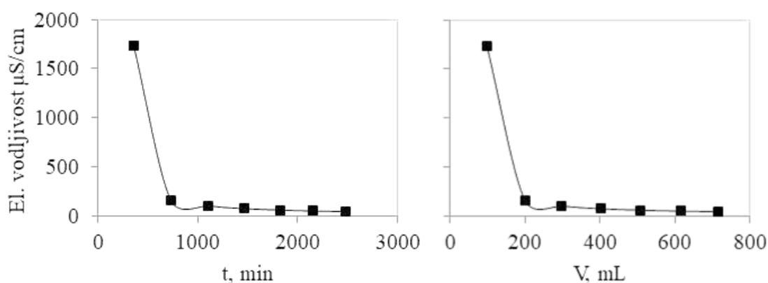
Slika 4.3. Rezultati električne vodljivosti praćeni tijekom desorpcije.
