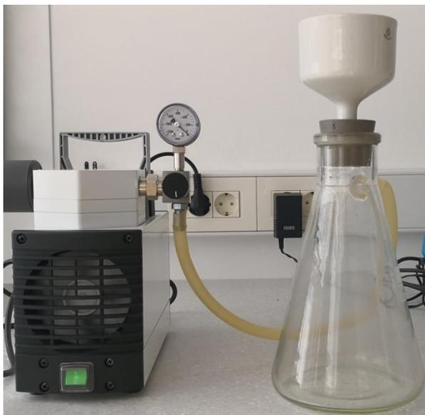
Slika 2.1 Aparatura za vakuum filtraciju.
