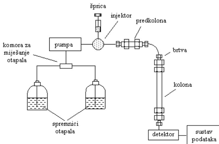
**Slika 17.** Shematski prikaz HPLC-a.<sup>24</sup>
