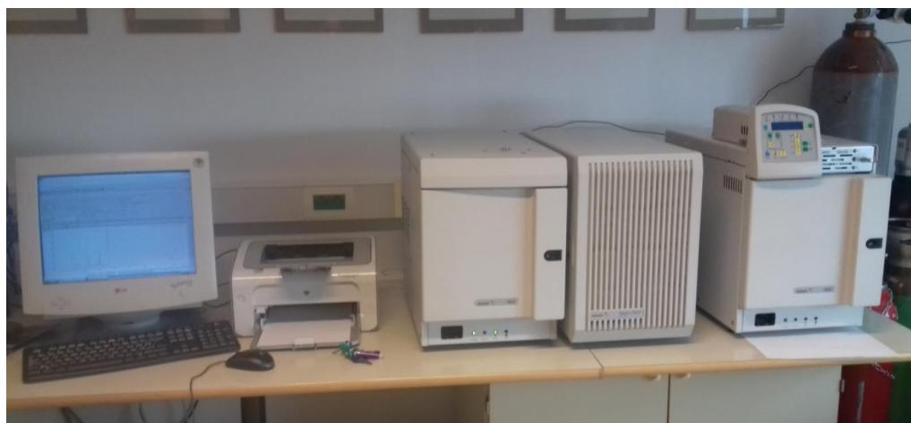
Slika 36. Korištena GC-MS instrumentacija.
