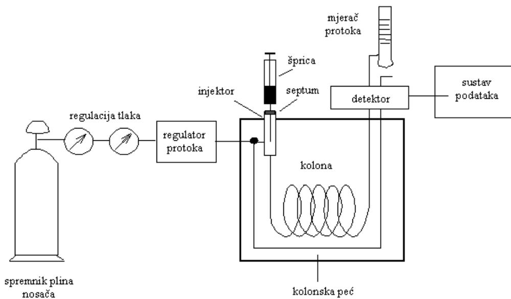
Slika 13. Shematski prikaz plinskog kromatografa.<sup>19</sup>
