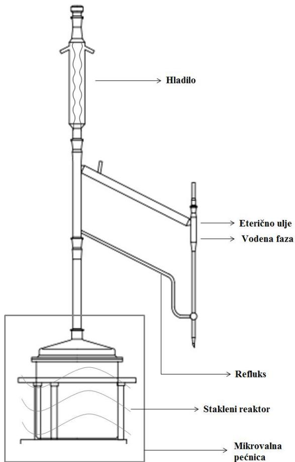
**Slika 9.** Sustav za mikrovalnu destilaciju eteričnih ulja.<sup>13</sup>
