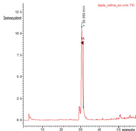
**Slika 45.** Kromatogram ukupne ionske jakosti ekstrakta bijele rotkve.
