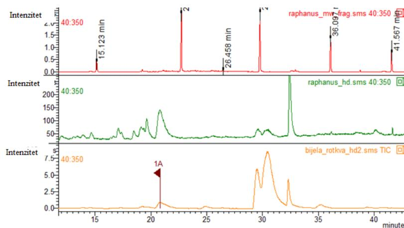
**Slika 41.** Kromatogram ukupne ionske jakosti izolata rotkvice i bijele rotkve.
