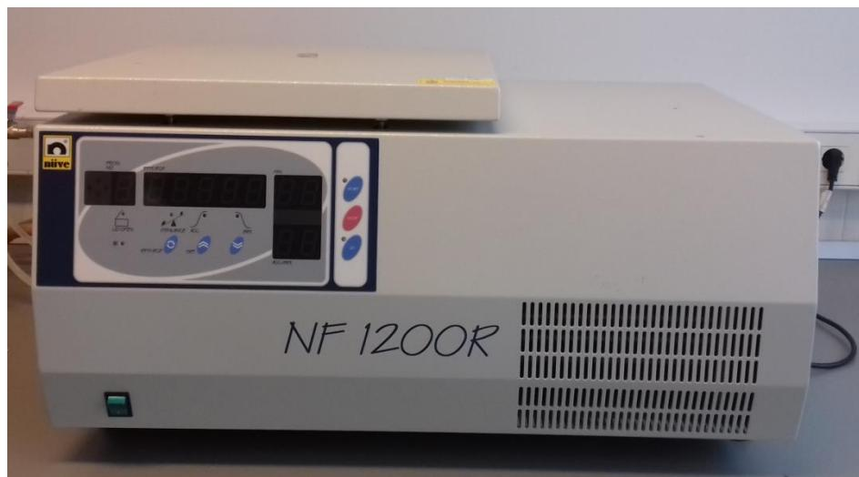
**Slika 32.** Centrifuga korištena za pripremu otopine sulfataze.
