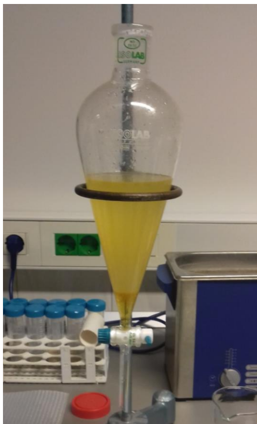
Slika 29. Obrada ekstrakta nakon mikrovalne ekstrakcije.
