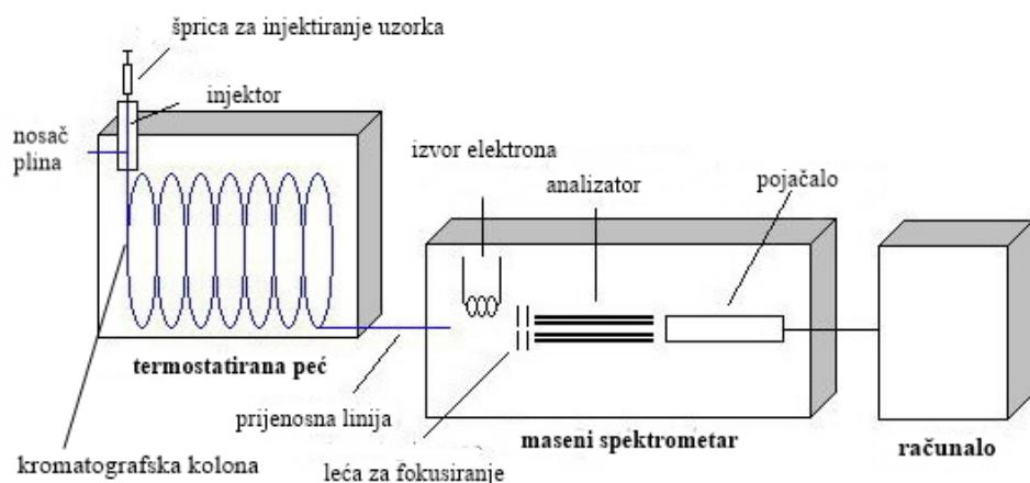
**Slika 16.** Shematski prikaz vezanog sustava GC-MS.<sup>21</sup>
