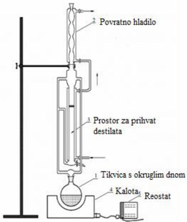
**Slika 8.** Modificirana aparatura po Clevengeru.<sup>4</sup>
