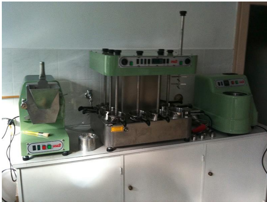
Slika 16. Laboratorijska uljara Abencor mc2
