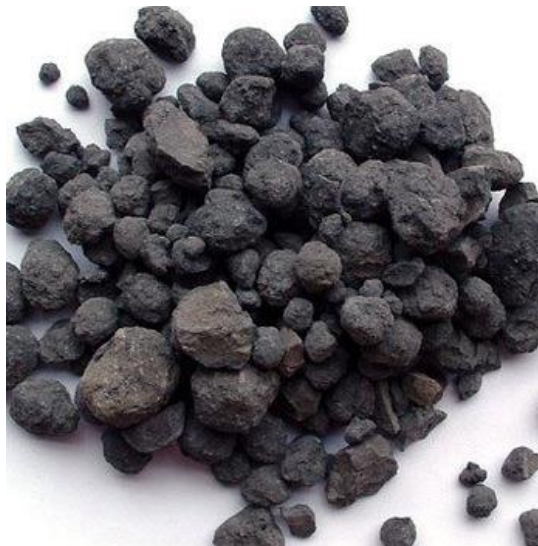
Slika 1. Portland cementni klinker 4
