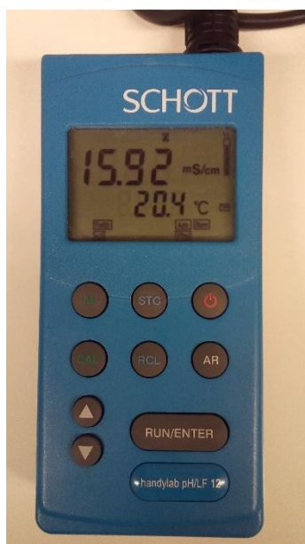
Slika 13. Uređaj za praćenje promjene provodnosti u cementnim suspenzijama.
