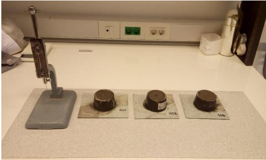
Slika 16. Određivanje početka i kraja vezanja Vicatovim aparatom
