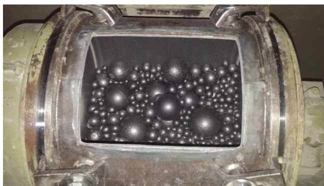
Slika 12. Punjenje poluindustrijskog horizontalnog mlina s čeličnim kuglama [12]
