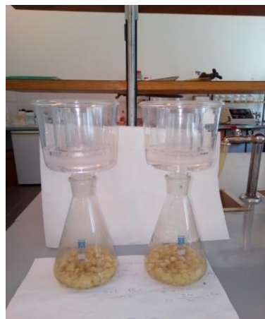
Slika 12. Završetak fermentacije sustava imobiliziranog na želatini
