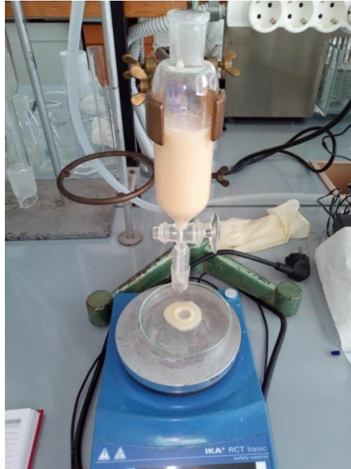
Slika 9. Dokapavanje suspenzije stanica kvasca u želatini
