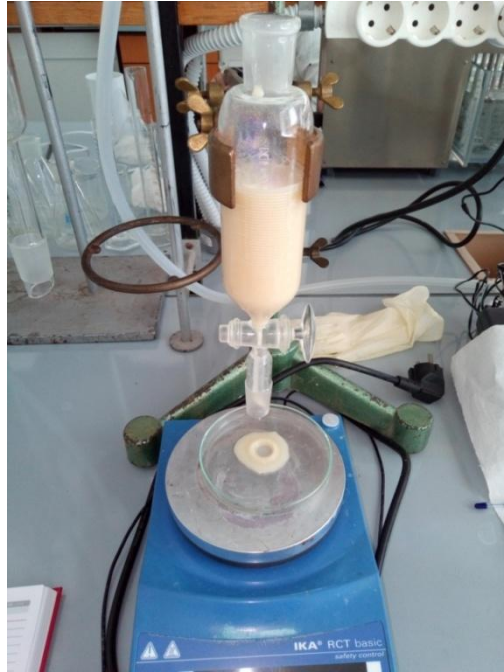
Slika 9. Dokapavanje suspenzije stanica kvasca u želatini
