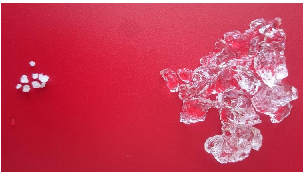
Slika 1. Hidrogel poli(akril-amid) prije i nakon bubrenja u vodi
