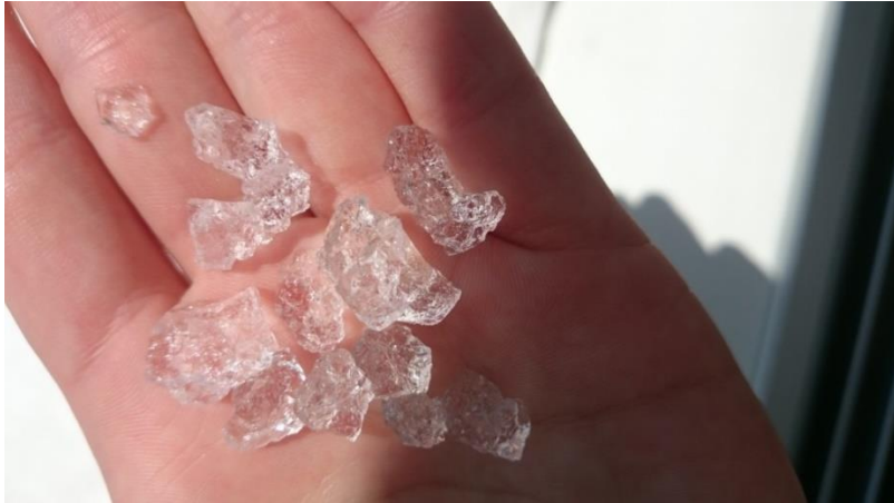
Slika 7. Poli(akril-amid) nakon bubrenja u vodovodnoj vodi
