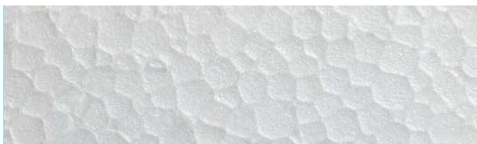
Slika 7. Struktura pjenastog polistirena 11
