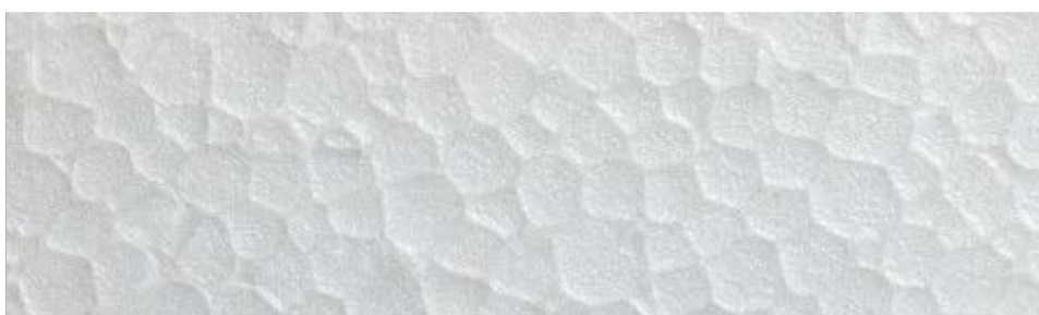
Slika 7. Struktura pjenastog polistirena 11
