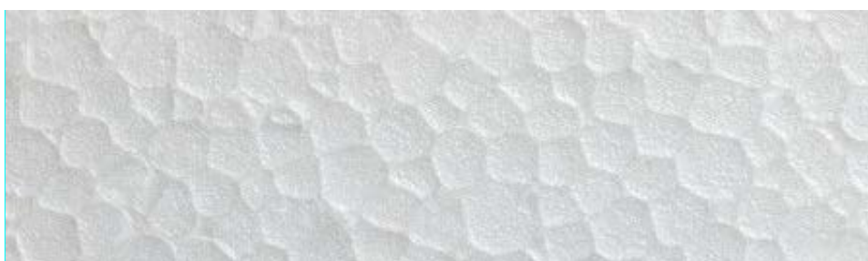
Slika 7. Struktura pjenastog polistirena 11
