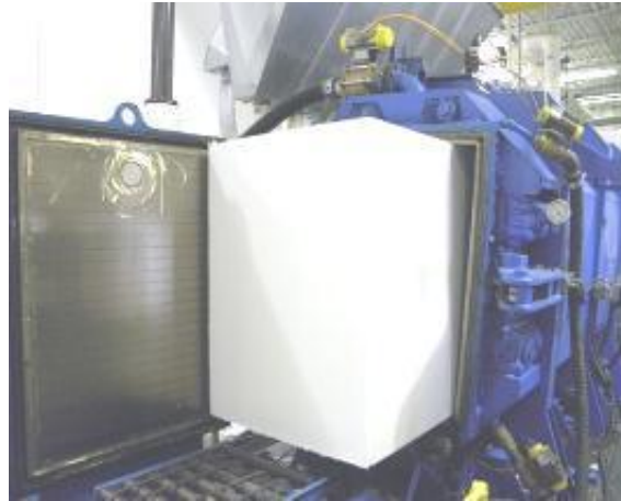
Slika 12. Proizvodnja stiropor blokova 13
