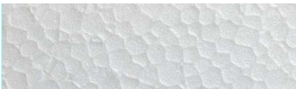
Slika 7. Struktura pjenastog polistirena 11
