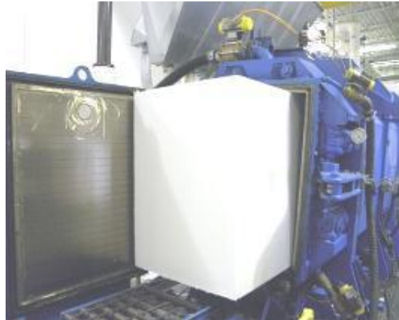
Slika 12. Proizvodnja stiropor blokova 13
