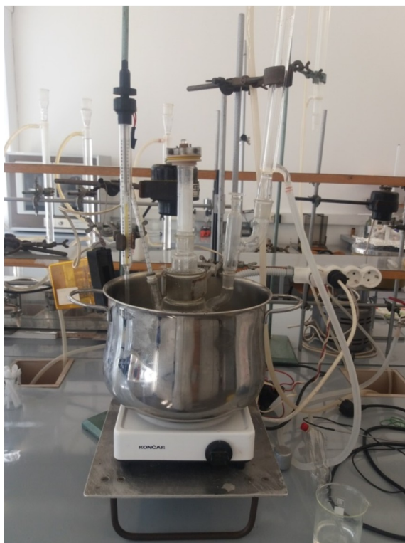
Slika 10. Aparatura potrebna za pripravu sapuna koristeći metodu I
