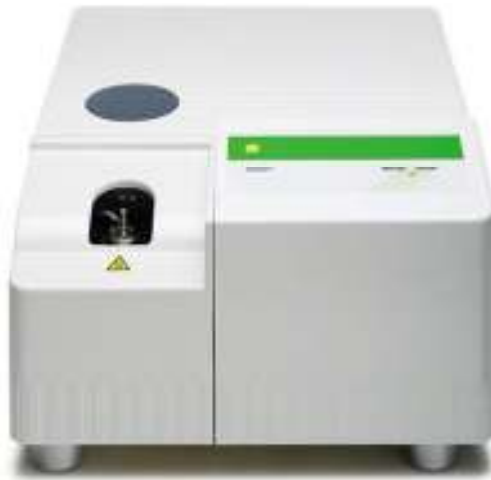
Slika 30. Diferencijalni pretražni kalorimetar DSC823 e (Mettler Toledo)
