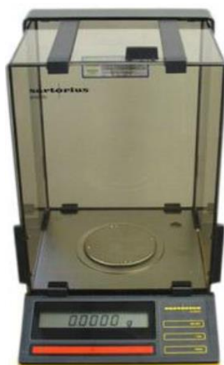
Slika 13. Laboratorijska analitička vaga (Sartorius A200S)
