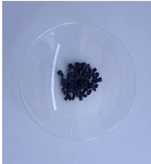
Slika 7. Uzorak 1 (polipropilen s dodatkom 20% mineralnog punila)
