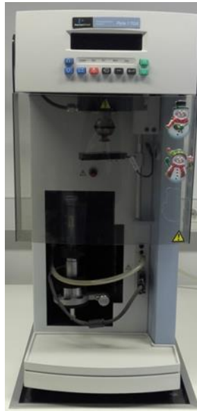
Slika 6. Aparatura za termogravimetrijsku analizu Pyris 1 TGA (Perkin-Elmer)
