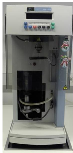
Slika 6. Aparatura za termogravimetrijsku analizu Pyris 1 TGA (Perkin-Elmer)
