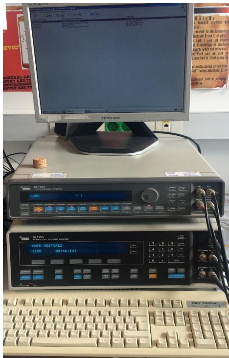
Slika 19. Uređaj za elektrokemijsku impedancijsku spektroskopiju
