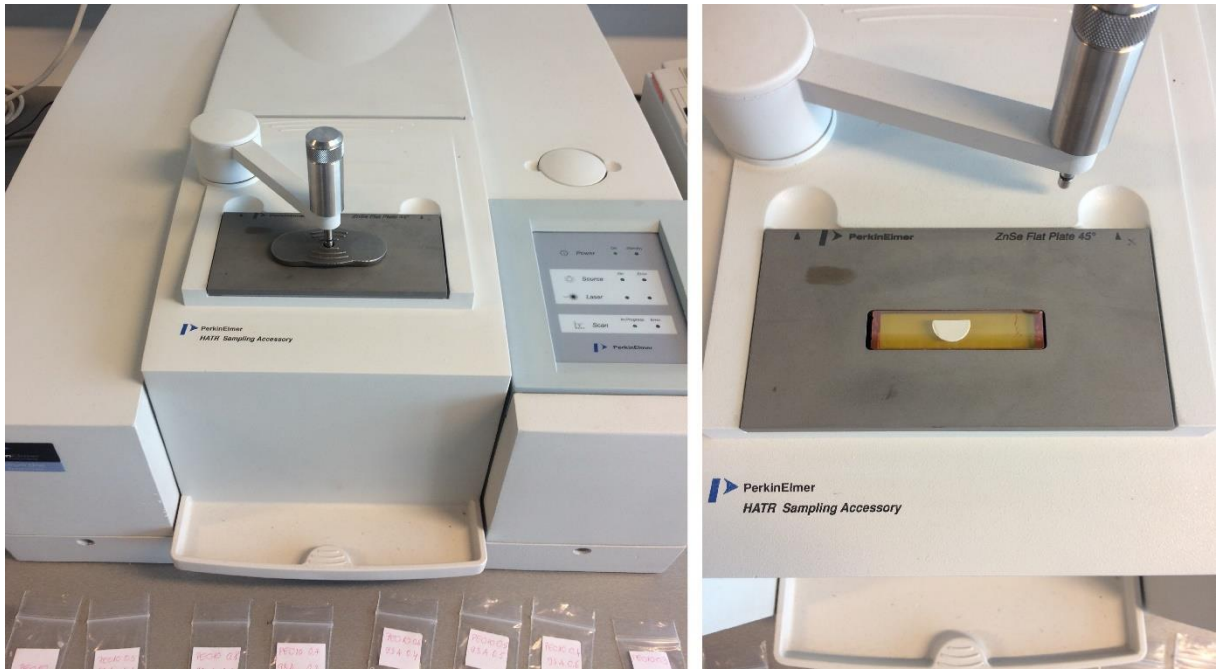
Slika 18. HATR tehnika na Perkin-Elmer Spectrum One FT-IR spektrometru
