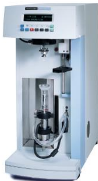
Slika 17. Pyris 1 TGA termogravimetar
