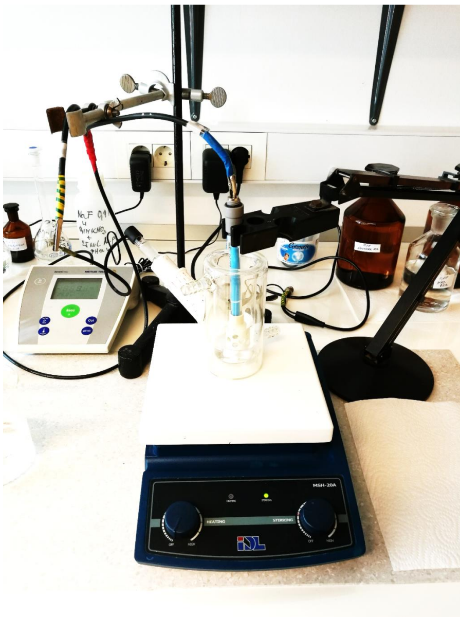
Slika 3. Uređaj za potenciometrijska određivanja
