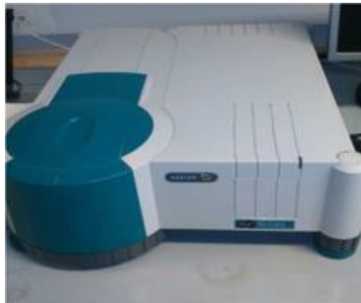
Slika 16. Određivanje lakopristupačnog fosfora AL-metodom
