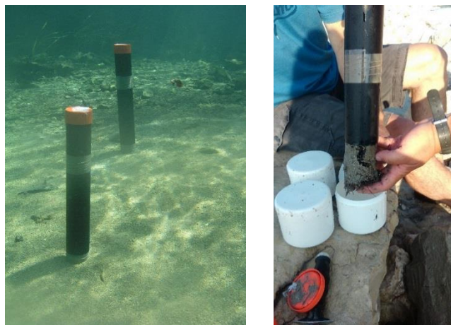
Slika 3. Prikupljanje uzoraka korerom i prenošenje u dezinficirane posude za transport
