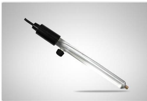
**Slika 1.** Dvospojna referentna elektroda<sup>2</sup>
