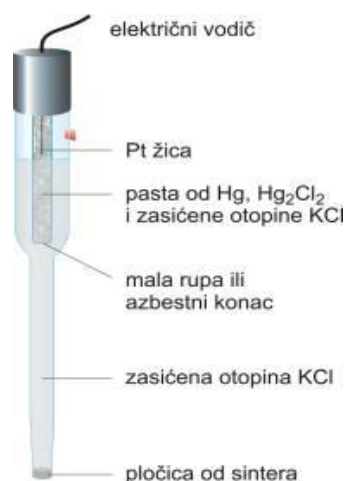
Slika 5. Prikaz kalomelove elektrode 3
