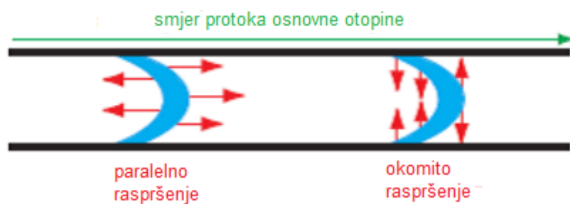
Slika 2-6 Okomito i paralelno raspršenje – utjecaj na koncentracijski gradijent [13]
