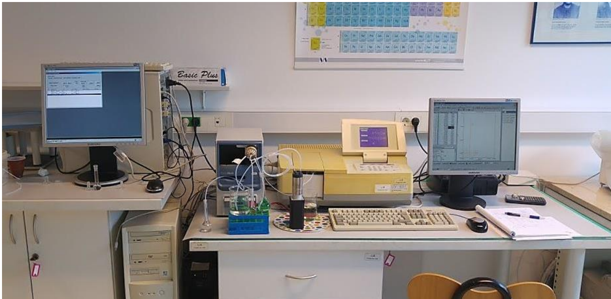
Slika 3.1. Sustav korišten prilikom razvoja i validacije SIA metode za određivanje cisteina
