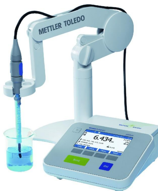
Slika 3.5. Milivoltmetar korišten za mjerenje pH vrijednosti [20]
