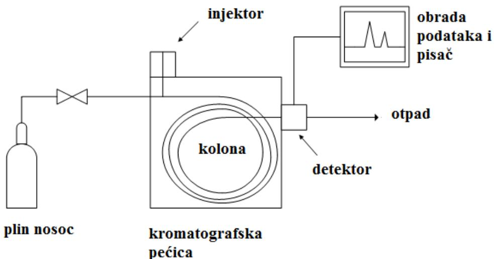
**Slika 3.** Shematski prikaz osnovnih dijelova plinskog kromatografa (43).
