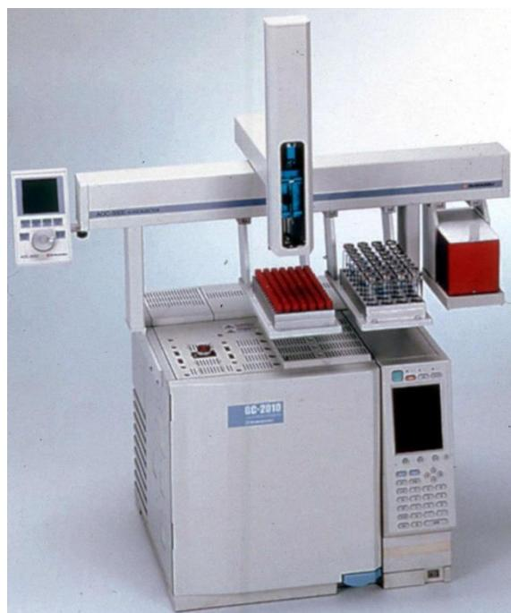
**Slika 5.** Plinski kromatograf s plameno-ionizacijskim detektorom; Shimadzu GC-2010 (46).
