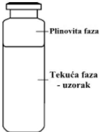
**Slika 9.** Staklena bočica s uzorkom za „headspace“ analizu. [39]
