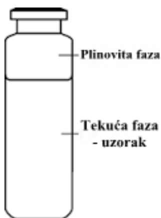
Slika 9. Staklena bočica s uzorkom za „headspace“ analizu. [39]
