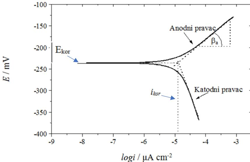
**Slika 13.** Tafelova metoda određivanja korozijских parametara iz polarizacijskih mjerena<sup>(14)</sup>
