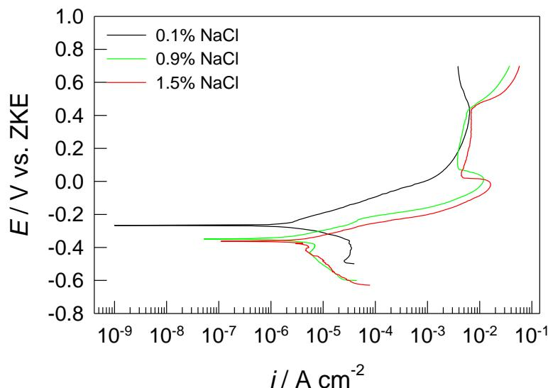
**Slika 26.** Potenciodinamičke polarizacijske krivulje za CuAlNi leguru u NaCl otopini pri  $pH = 7,4$  i  $T = 37^{\circ}\text{C}$
