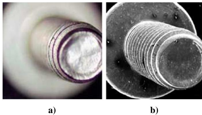
**Slika 14.** Usporedni prikaz slike objekta dobiven pomoću optičkog mikroskopa a) i pretražnog elektronskog mikroskopa (SEM) b)<sup>(12)</sup>
