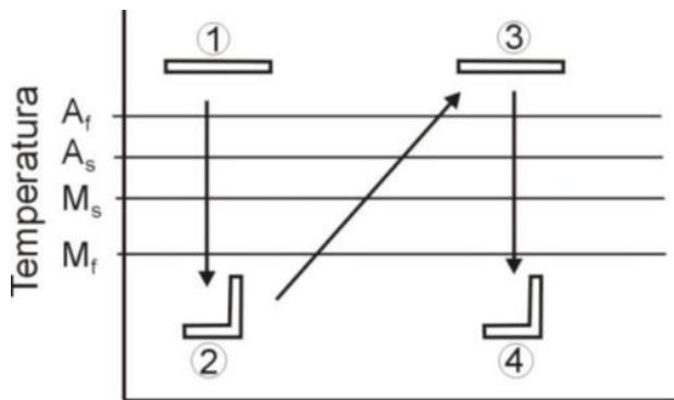
Slika 6. Shematski prikaz dvosmjernog efekta prisjetljivosti oblika<sup>(7)</sup>
