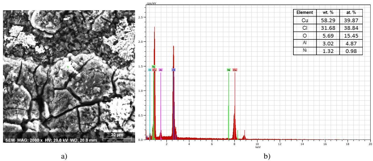
**Slika 33.** SEM snimka površine uzorka CuAlNi legure nakon potenciodinamičkog polarizacijskog mjerena u 0,9 % NaCl otopini (uvećanje 2000 puta) i pripadajuća EDS analiza
