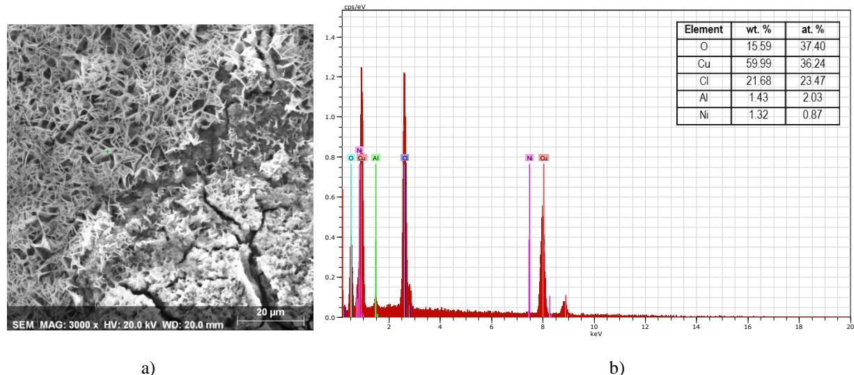
**Slika 32.** SEM snimka površine uzorka CuAlNi legure nakon potenciodinamičkog polarizacijskog mjerena u 0,1 % NaCl otopini (uvećanje 3000 puta) i pripadajuća EDS analiza
