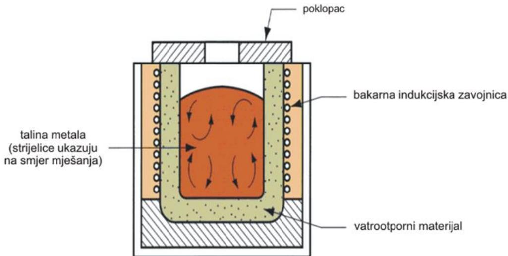
**Slika 8.** Shematski prikaz induksijskog taljenja<sup>(6)</sup>
