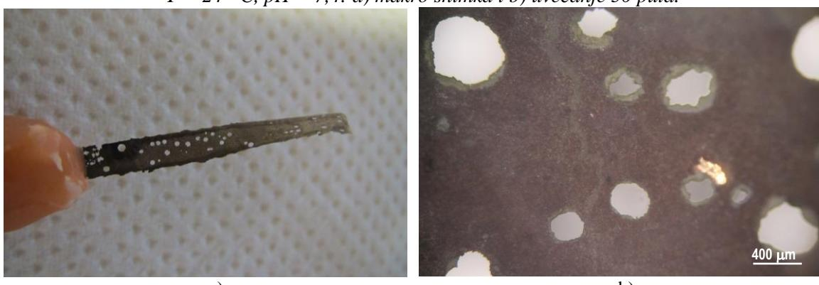
**Slika 28.** Snimke površine CuAlNi elektrode nakon polarizacijskih mjerena u 0,9 % NaCl otopini,  $T = 37 \text{ } ^\circ\text{C}$ ,  $\text{pH} = 7,4$ : a) makro snimka i b) uvećanje 50 puta.
