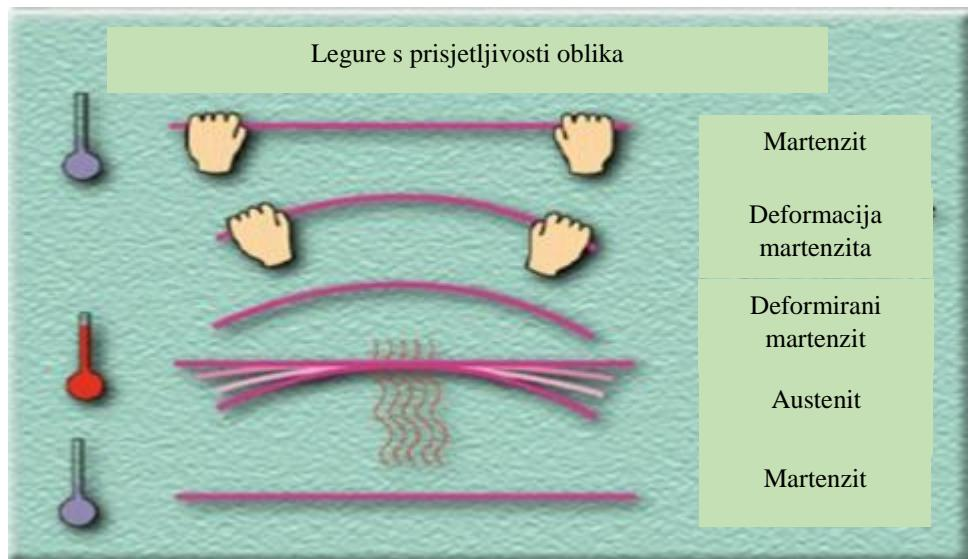
Slika 1. Transformacija legura s efektom prisjetljivosti oblika<sup>(4)</sup>
