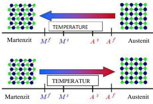
**Slika 3.** Temperaturno inducirane fazne transformacije SMA legura bez djelovanja mehaničke sile<sup>(4)</sup>
