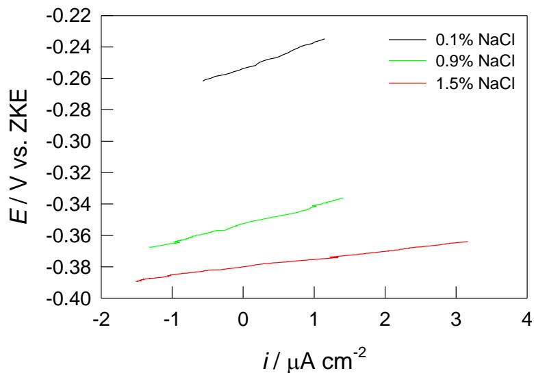
**Slika 24.** Linearni djelovi polarizacijskih krivulja dobiveni metodom linearne polarizacije za CuAlNi leguru u NaCl otopini pri pH = 7,4 i T = 37 °C
