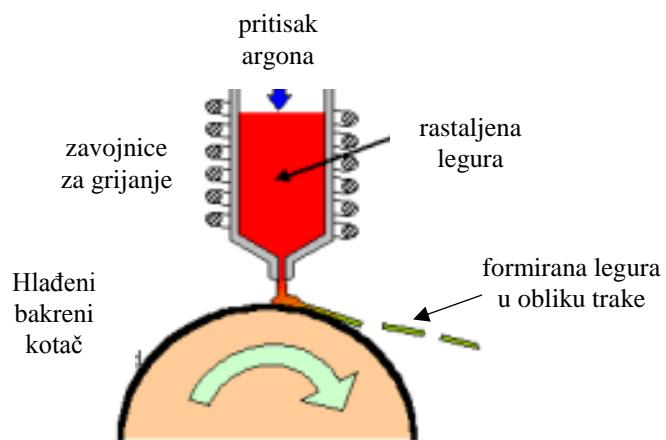
Slika 16. Dobivanje trake legure UBK metodom<sup>(22)</sup>
