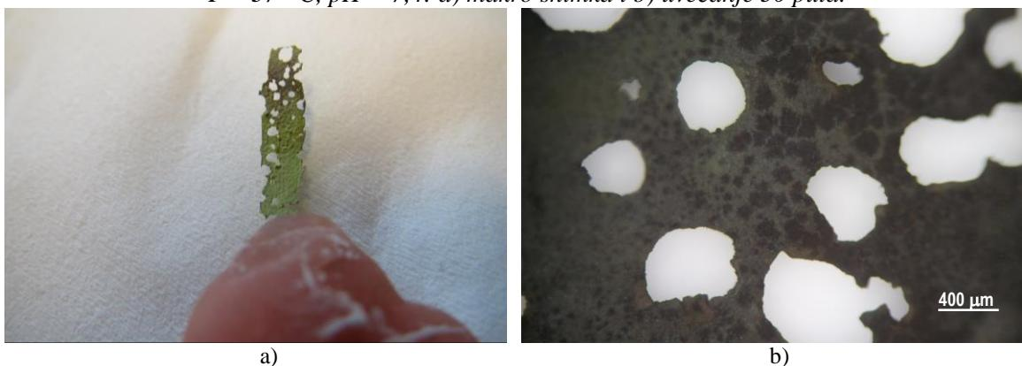
**Slika 31.** Snimke površine CuAlNi elektrode nakon polarizacijskih mjerena u 1,5 % NaCl otopini,  $T = 37^{\circ}\text{C}$ ,  $\text{pH} = 7,4$ : a) makro snimka i b) uvećanje 50 puta.
