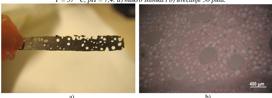
**Slika 29.** Snimke površine CuAlNi elektrode nakon polarizacijskih mjerena u 0,9 % NaCl otopini,  $T = 50 \text{ } ^\circ\text{C}$ ,  $\text{pH} = 7,4$ : a) makro snimka i b) uvećanje 50 puta
