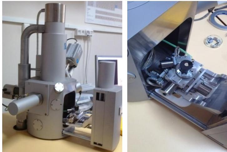
**Slika 20.** Pretražni elektronski mikroskop Tescan Vega TS5136LS
