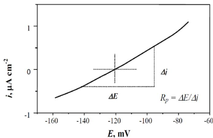
Slika 12. Određivanje polarizacijskog otpora metodom linearne polarizacije<sup>(14)</sup>
