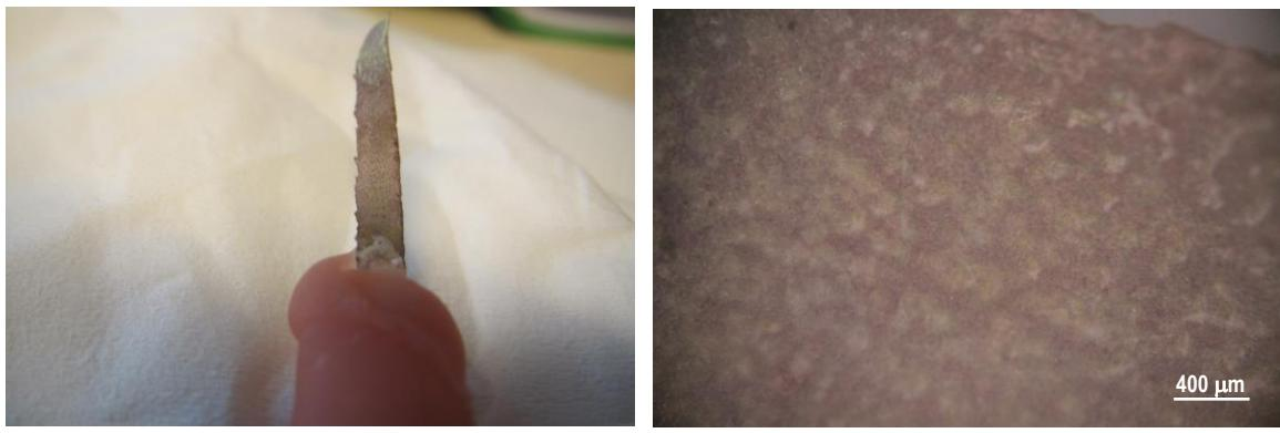
**Slika 30.** Snimke površine CuAlNi elektrode nakon polarizacijskih mjerena u 0,1 % NaCl otopini,  $T = 37^{\circ}\text{C}$ ,  $\text{pH} = 7,4$ : a) makro snimka i b) uvećanje 50 puta.
