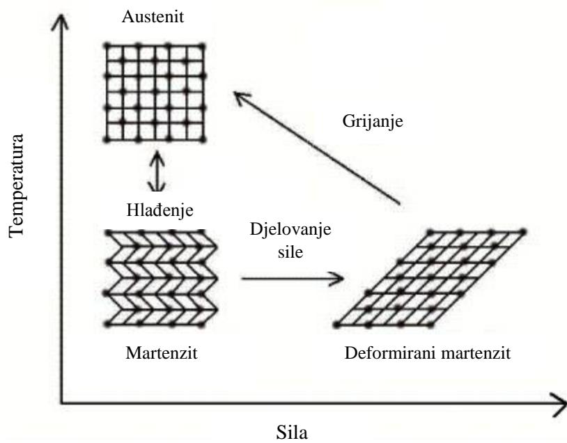
**Slika 2.** Ciklus promjena strukture za SMA legure<sup>(5)</sup>
