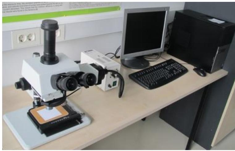
**Slika 19.** Optički mikroskop MXFMS-BD, Ningbo Sunny Instruments co.
