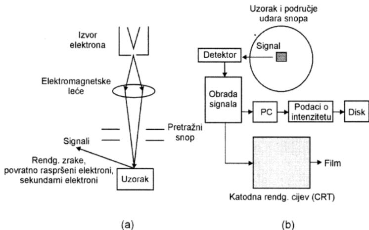
**Slika 15.** Shematski prikaz pretražnog elektronskog mikroskopa: a) nastanak elektronskog snopa i fokusiranje u točku na površini uzorka; b) pojačavanje detektiranih signala za različite analize<sup>(21)</sup>
