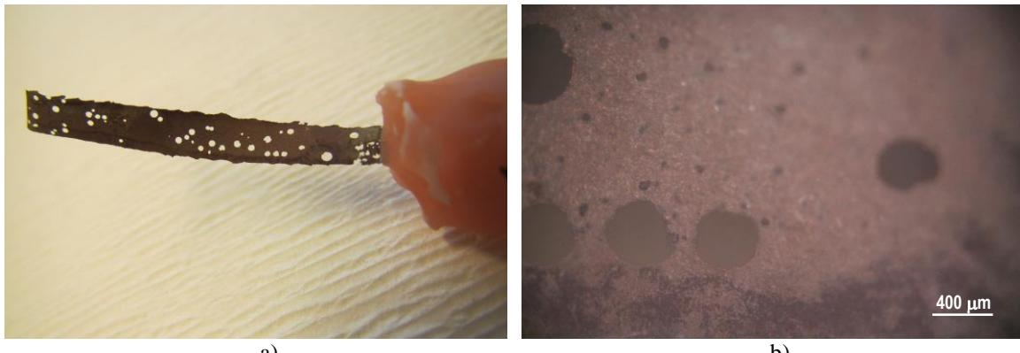
**Slika 27.** Snimke površine CuAlNi elektrode nakon polarizacijskih mjerena u 0,9 % NaCl otopini,  $T = 24 \text{ } ^\circ\text{C}$ ,  $\text{pH} = 7,4$ : a) makro snimka i b) uvećanje 50 puta.
