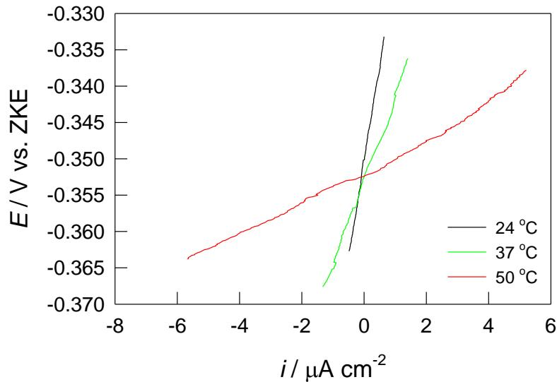
**Slika 23.** Linearni djelovi polarizacijskih krivulja dobiveni metodom linearne polarizacije za CuAlNi leguru u 0,9 % NaCl otopini pri pH = 7,4 i različitim temperaturama elektrolita
