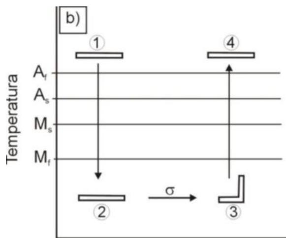
**Slika 5.** Shematski prikaz jednosmjernog efekta prisjetljivosti oblika<sup>(6)</sup>
