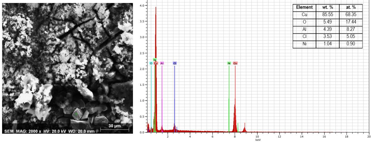
**Slika 34.** SEM snimka površine uzorka CuAlNi legure nakon potenciodinamičkog polarizacijskog mjerjenja u 1,5 % NaCl otopini (uvećanje 2000 puta) i pripadajuća EDS analiza
