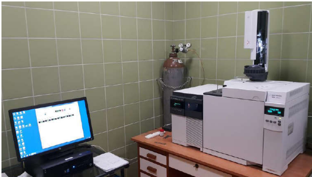
Slika 14. Vezani sustav plinska kromatografija-masena spektrometrija (GC-MS)
