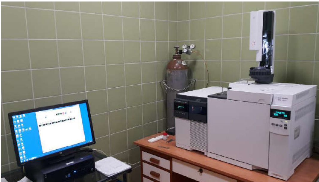
Slika 14. Vezani sustav plinska kromatografija-masena spektrometrija (GC-MS)
