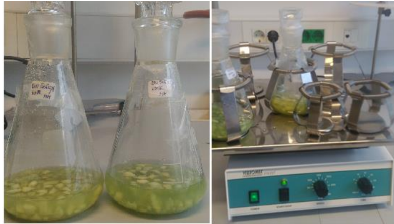
Slika 2.8. Ekstrakcija potpomognuta miješanjem na tresilici
