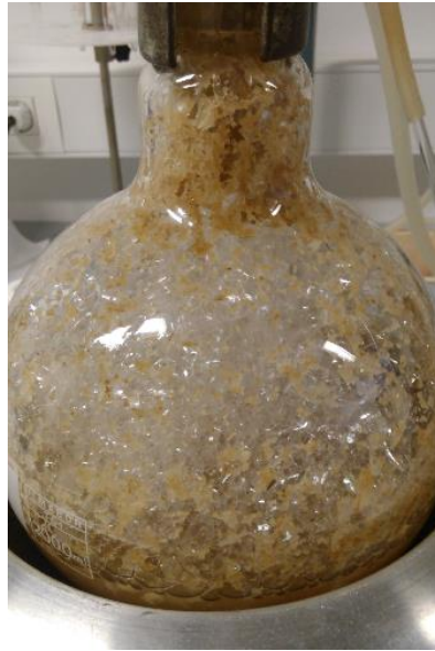
Slika 2.6. Pjenjenje tijekom destilacije
