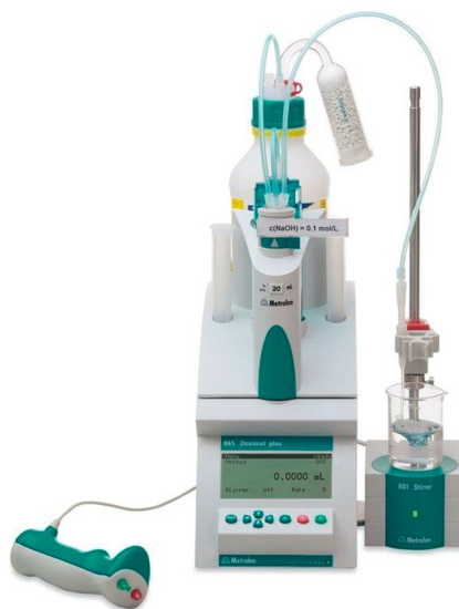
Slika 2.2. Automatski titrator "Methrom Dozimati" 30 .
