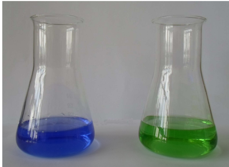
Slika 2.3. Prijelaz boje u točki ekvivalencije pri kompleksometrijskoj titraciji bakra uz indikator krom azurol S.
