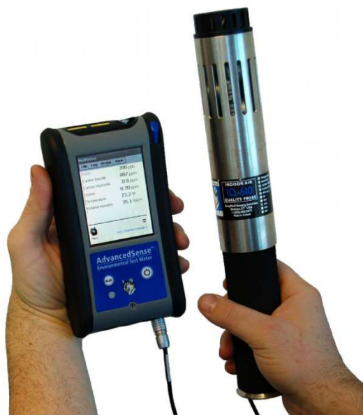
Slika 2.2. Uređaj za mjerenje koncentracije CO, NO 2 , SO 2 i temperature (Advanced Sense Environmental Test Meter). 1
