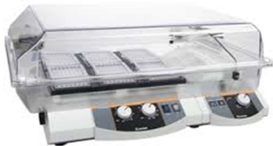
Slika 2.3. Laboratorijska tresilica "Heidolph unimax 1010"
