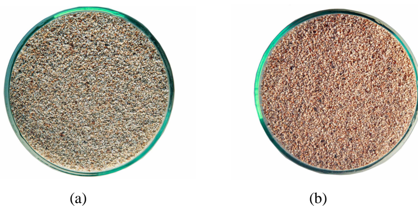
Slika 2.1. Usporedba prirodnog (a) i Fe(III)-modificiranog zeolita (b)
