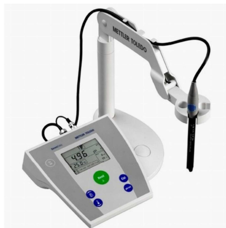
Slika 2.3. pH metar „Mettler Toledo“.
