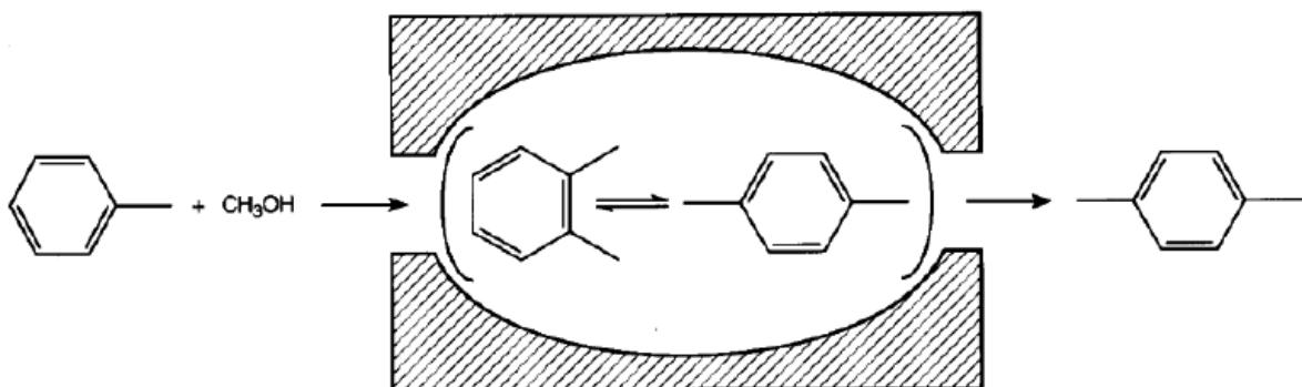
*Slika 1.5. Primjer selektivnosti zeolita prema obliku molekule produkta na reakciji alkiliranja(metiliranja) toluena<sup>8</sup>*
