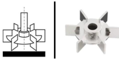
*Slika 1.12. Disk turbine (eng. disk turbine, Rushton)<sup>20</sup>*
