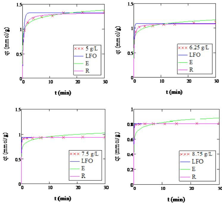
**Slika 3.9 .** Grafički prikaz količine uklonjenog metala po masi zeolita u vremenu  $t$ , za promjer miješala  $8,0\text{ cm}$  te prikaz slaganja podataka s odabranim kinetičkim modelima.
