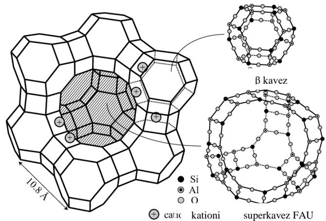
*Slika 1.7. Trodimenzionalna struktura FAU zeolita*
