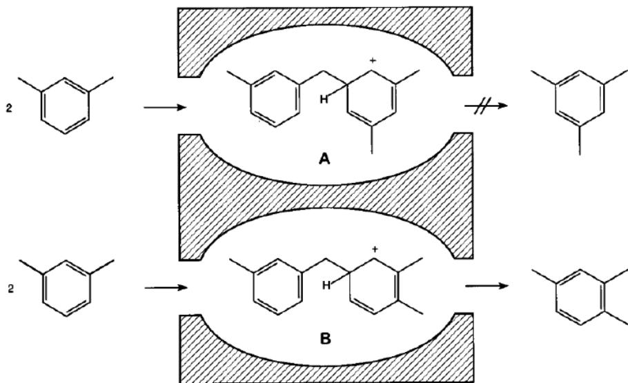
**Slika 1.6.** Primjer selektivnosti s obzirom na oblik molekule u prijelaznom stanju na reakciji disproporcionaliranja<sup>1</sup> m-ksilena<sup>8</sup>
