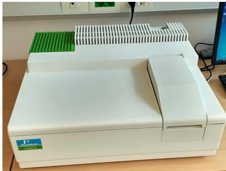
*Slika 2.3. Spektrofotometar*
