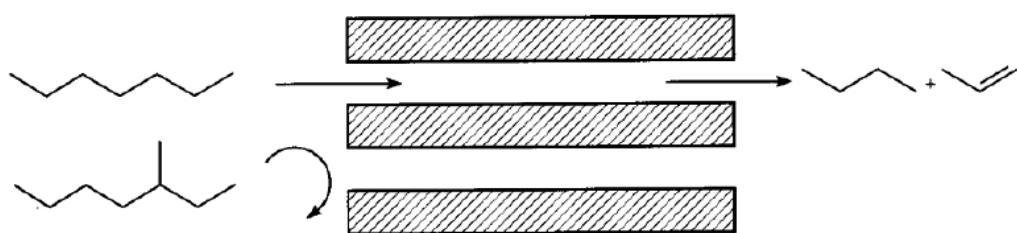
*Slika 1.4. Primjer selektivnosti zeolita prema obliku molekule reaktanta na reakciji cijepanja ugljikovodika<sup>8</sup>*
