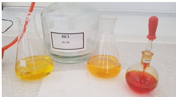
Slika 4. Određivanje karbonatne tvrdoće titracijom uzorka izvorske vode s otopinom klorovodične kiseline uz indikator metiloranž do prijelaza boje iz žute u narančastu
