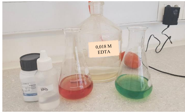
Slika 5. Određivanje ukupne tvrdoće titracijom uzorka izvorske vode s otopinom 0,018 M EDTA uz koncentrirani amonijak i pufer tabletu do prijelaza boje iz crvenkaste u zelenu
