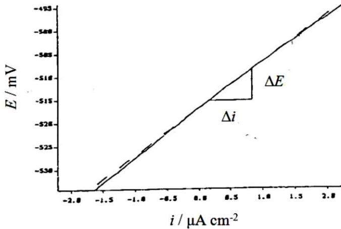
**Slika 14.** Određivanje polarizacijskog otpora iz nagiba polarizacijske krivulje u blizini koroziskog potencijala.
