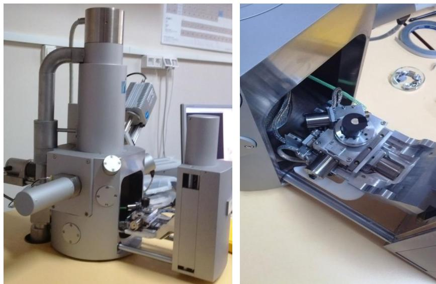
Slika 19. Pretražni elektronski mikroskop Tescan Vega TS5136LS
