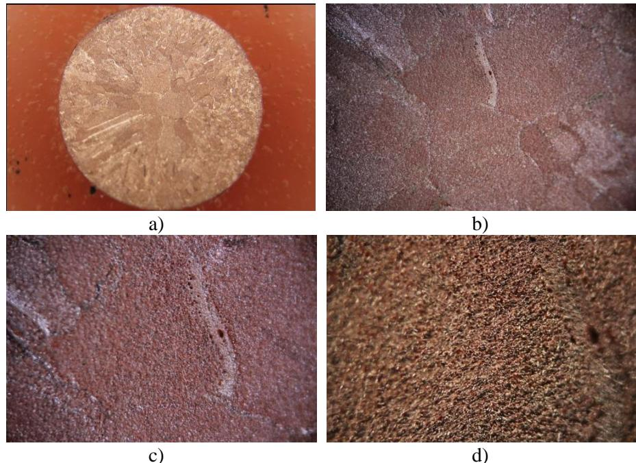
**Slika 33.** Snimke površine CuAlMn elektrode nakon polarizacijskih mjerena u mirujućoj 0,9 % NaCl otopini,  $T = 37^{\circ}\text{C}$ , pH = 5,4: a) makro snimka, b) uvećanje 50 puta, c) uvećanje 100 puta, d) uvećanje 200 puta
