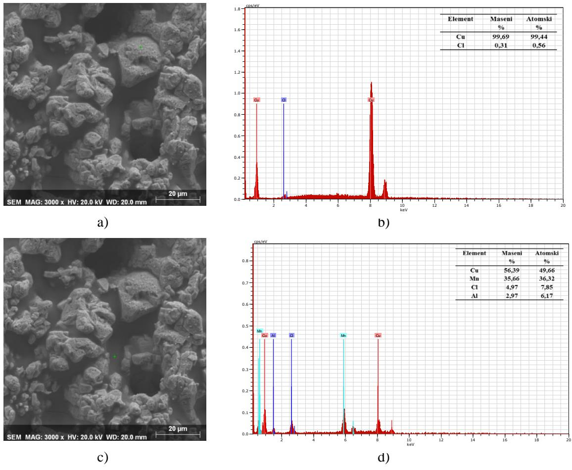
**Slika 36.** SEM snimke površine uzorka CuAlMn legure nakon polarizacijskog mjerjenja u 0,9 % NaCl otopini ( $\text{pH} = 7,4$  i  $T = 50^{\circ}\text{C}$ ) uz uvećanje 3000 puta a) i c) i pripadajuće EDS analize b) i d)
