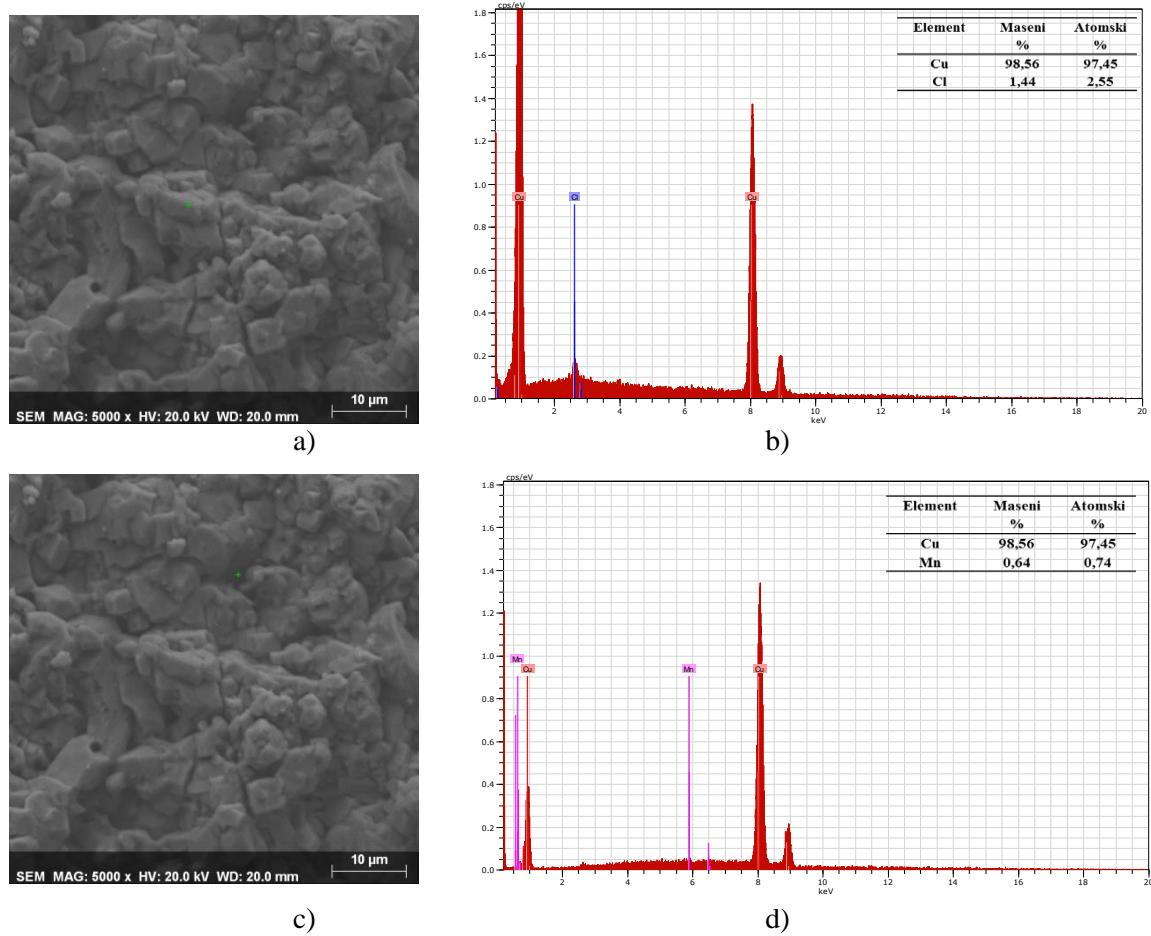
**Slika 35.** SEM snimke površine uzorka CuAlMn legure nakon polarizacijskog mjerena u 0,9 % NaCl otopini ( $\text{pH} = 7,4$  i  $T = 37^{\circ}\text{C}$ ) uz uvećanje 5000 puta a) i c) i pripadajuće EDS analize b) i d)
