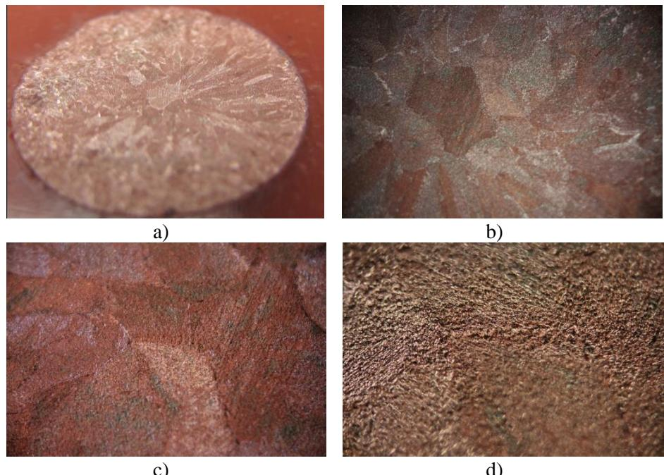
**Slika 29.** Snimke površine CuAlMn elektrode nakon polarizacijskih mjerena u mirujućoj 0,9 % NaCl otopini,  $T = 25 \text{ }^{\circ}\text{C}$ ,  $pH = 7,4$ : a) makro snimka, b) uvećanje 50 puta, c) uvećanje 100 puta, d) uvećanje 200 puta
