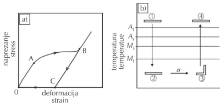
Slika 8. Dijagram naprezanja- deformacija za leguru s prisjetljivosti oblika a) i shematski prikaz jednosmjernog efekta prisjetljivosti oblika b)<sup>2,14</sup>
