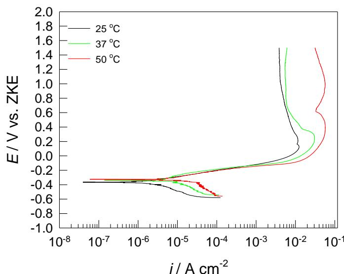
**Slika 27.** Potenciodinamičke polarizacijske krivulje za CuAlMn leguru u 0,9 % NaCl otopini pri  $25^\circ\text{C}$  (-),  $37^\circ\text{C}$  (-) i  $50^\circ\text{C}$  (-)
