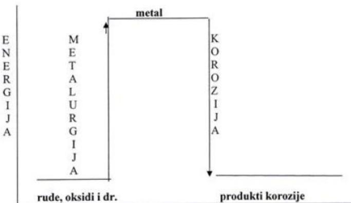
**Slika 10.** Prikaz energetske promjene pri dobivanju i koroziji metala<sup>1</sup>
