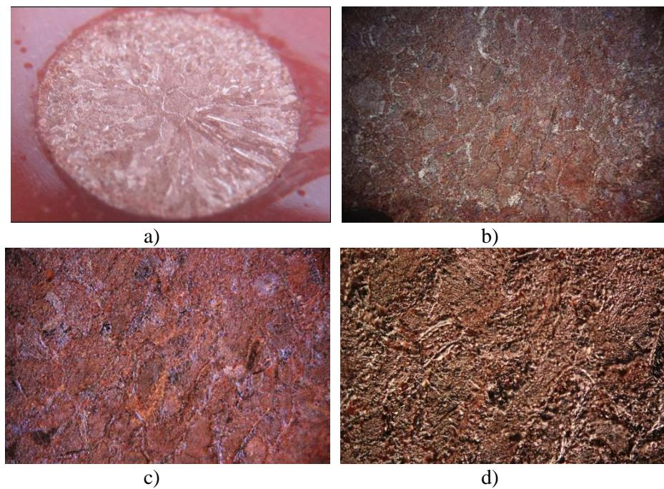
**Slika 32.** Snimke površine CuAlMn elektrode nakon polarizacijskih mjerjenja u 0,9 % NaCl otopini uz miješanje,  $T = 50$  °C,  $pH = 7,4$ : a) makro snimka, b) uvećanje 50 puta, c) uvećanje 100 puta, d) uvećanje 200 puta
