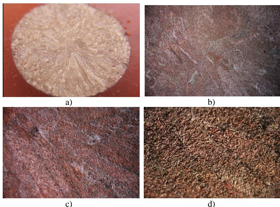
**Slika 34.** Snimke površine CuAlMn elektrode nakon polarizacijskih mjerena u mirujućoj 0,9 % NaCl otopini,  $T = 37^{\circ}\text{C}$ , pH = 3,4: a) makro snimka, b) uvećanje 50 puta, c) uvećanje 100 puta, d) uvećanje 200 puta
