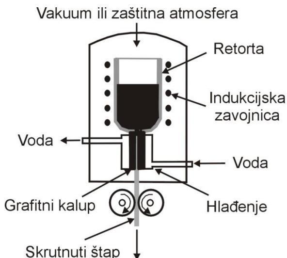
**Slika 16.** Shematski prikaz lijevanja slitine CuAlMn tehnologijom vertikalnog lijevanja<sup>15</sup>
