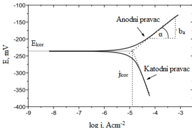
Slika 15. Tafelova metoda određivanja korozijskih parametara iz polarizacijskih mjerena
