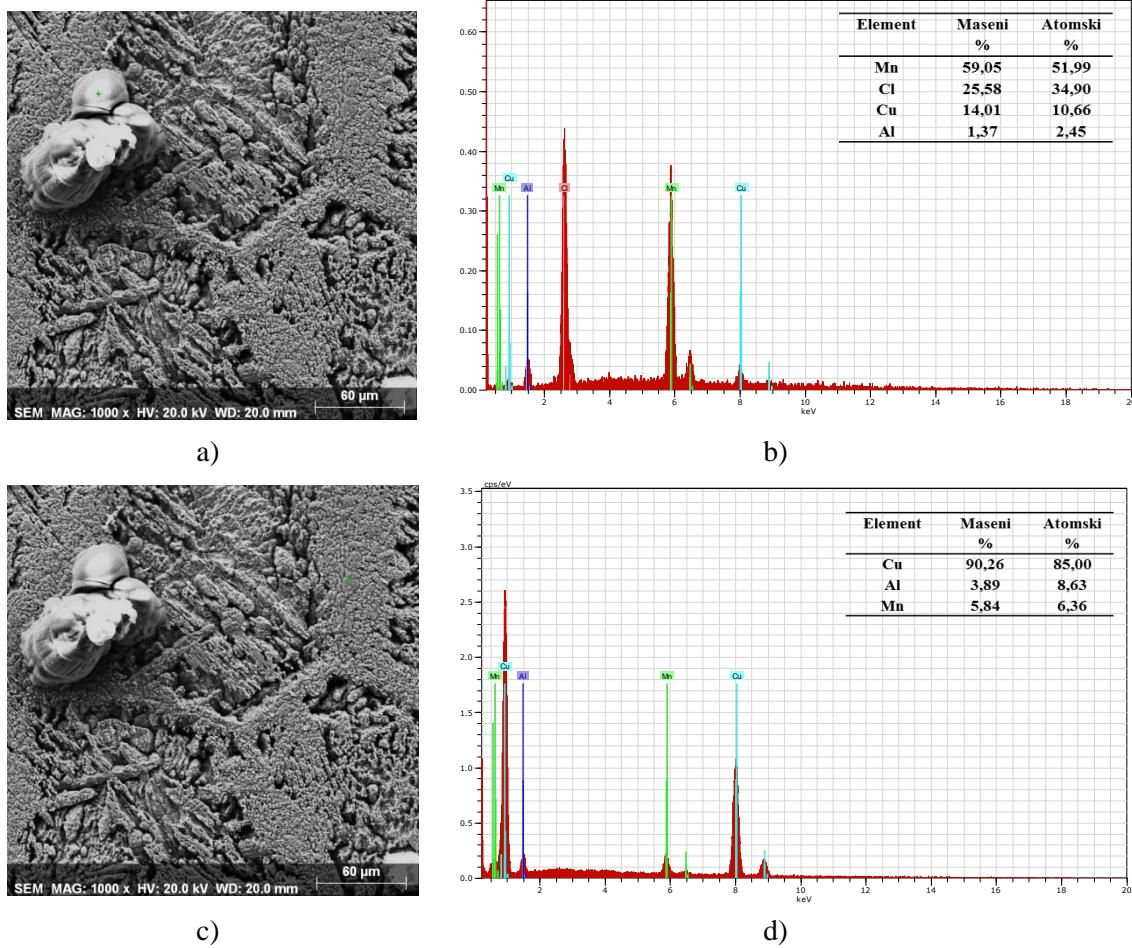
**Slika 37.** SEM snimke površine uzorka CuAlMn legure nakon polarizacijskog mjerjenja u 0,9 %  $\text{NaCl}$  otopini ( $\text{pH} = 7,4$  i  $T = 37^{\circ}\text{C}$ ) do potencijala od 0,463 V, uz uvećanje 1000 puta a) i c) i pripadajuće EDS analize b) i d)
