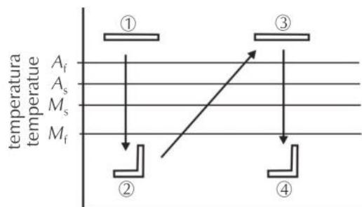
Slika 9. Shematski prikaz dvosmjernog efekta prisjetljivosti oblika<sup>2,14</sup>
