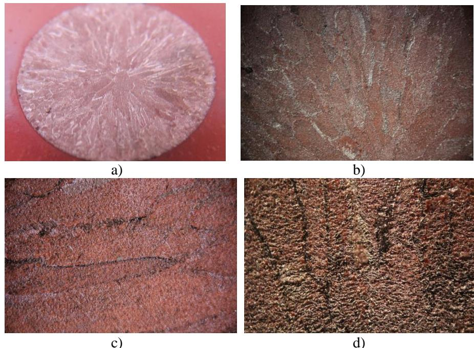
**Slika 31.** Snimke površine CuAlMn elektrode nakon polarizacijskih mjerjenja u mirujućoj 0,9 % NaCl otopini,  $T = 37$  °C,  $pH = 7,4$ : a) makro snimka, b) uvećanje 50 puta, c) uvećanje 100 puta, d) uvećanje 200 puta
