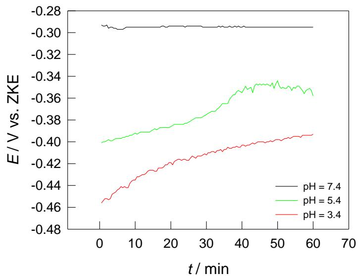
**Slika 22.** Vremenska ovisnost potencijala otvorenog strujnog kruga CuAlMn legure u 0,9 %  $\text{NaCl}$  otopini pri  $\text{pH} = 7,4$  (-),  $\text{pH} = 5,4$  (-) i  $\text{pH} = 3,4$  (-)
