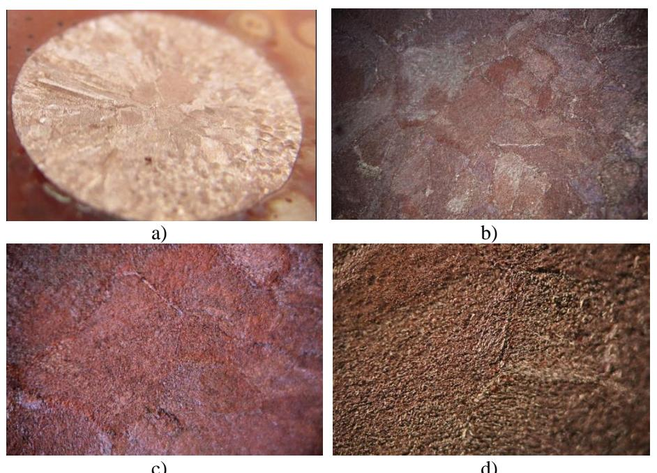
**Slika 30.** Snimke površine CuAlMn elektrode nakon polarizacijskih mjerena u 0,9 % NaCl otopini,  $T = 25 \text{ }^{\circ}\text{C}$ ,  $pH = 7,4$ : uz miješanje elektrolita: a) makro snimka, b) uvećanje 50 puta, c) uvećanje 100 puta, d) uvećanje 200 puta
