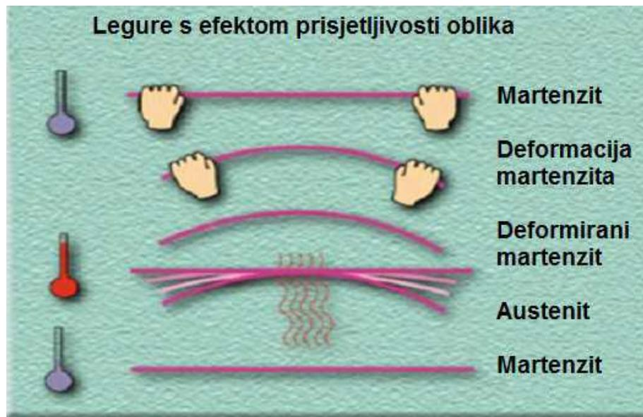
Slika 5. Transformacija legura s efektom prisjetljivosti oblika<sup>12</sup>
