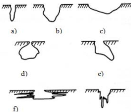
**Slika 12.** Različiti oblici jamičaste korozije: a) uska, duboka; b) eliptična; c) široka, plitka; d) potpovršinska; e) izbočena; f) horizontalna i vertikalna<sup>21</sup>
