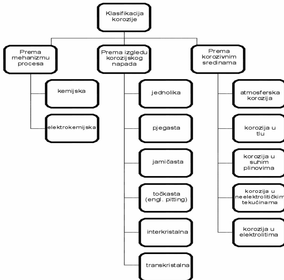
Slika 11. Klasifikacija korozije<sup>18</sup>
