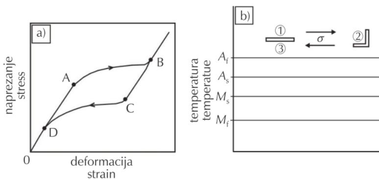
**Slika 7.** Dijagram naprezanje- deformacija legure s prisjetljivosti oblika a) i shematski prikaz pseudoelastičnosti b)<sup>2,14</sup>
