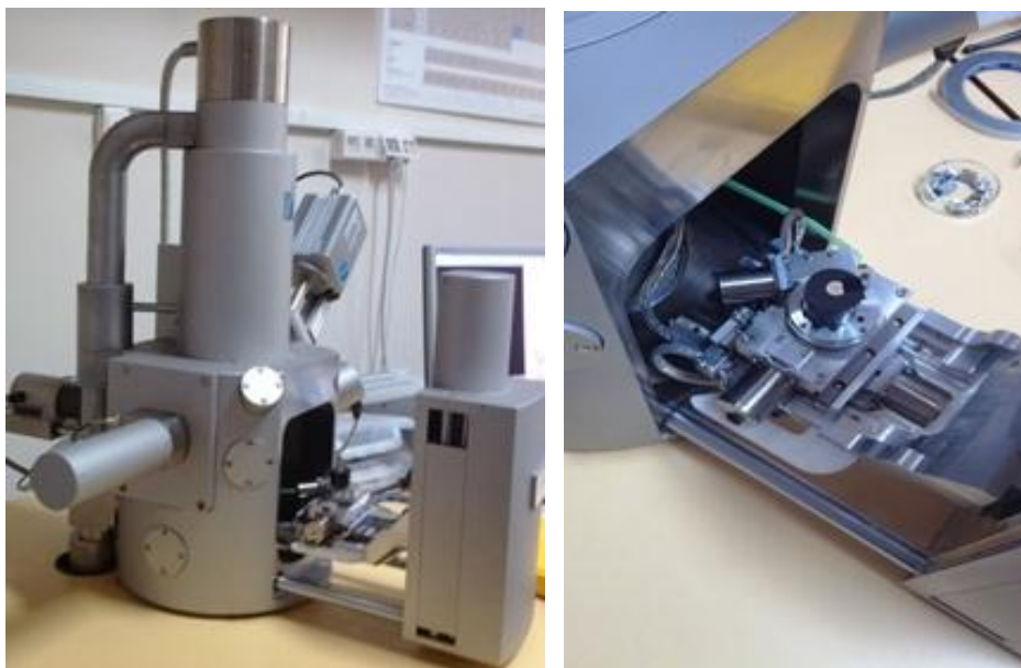
Slika 19. Pretražni elektronski mikroskop Tescan Vega TS5136LS
