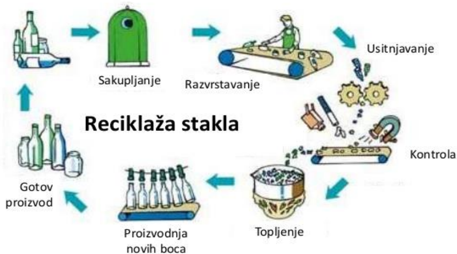
Slika 1. Shematski prikaz procesa reciklaže stakla 5
