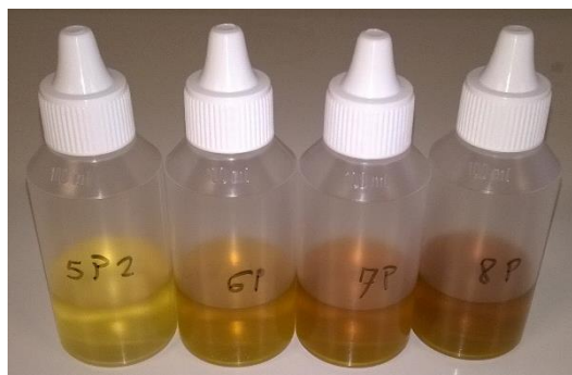
Slika 10. Otopine koloidnog srebra pripremljene demineraliziranom vodom s pH = 6,08 poredanih s lijeva na desno počevši s najnižom koncentracijom.
